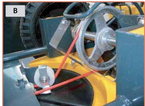
Der Riemen befindet sich in der in (B) gezeigten Position.
