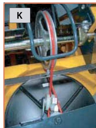
Den Riemen festhalten und das Antriebsrad drehen, um den Riemen in die Nut zu rollen. Überprüfen, dass der Riemen in der Scheibe sitzt (J und K). Die Ausrichtung des Riemens gegen B und C prüfen.
